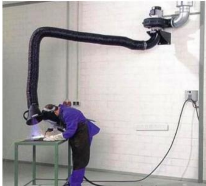
图 6-1 万向柔性吸气臂集气效果示意图
