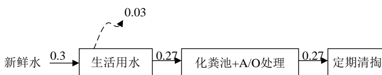
图 1-3 本项目水平衡图
