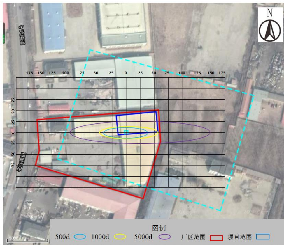
图 4.2-2 非正常状况下不同时间点泄漏点石油类超标距离（ 0.05\text{mg/L} ）示意
