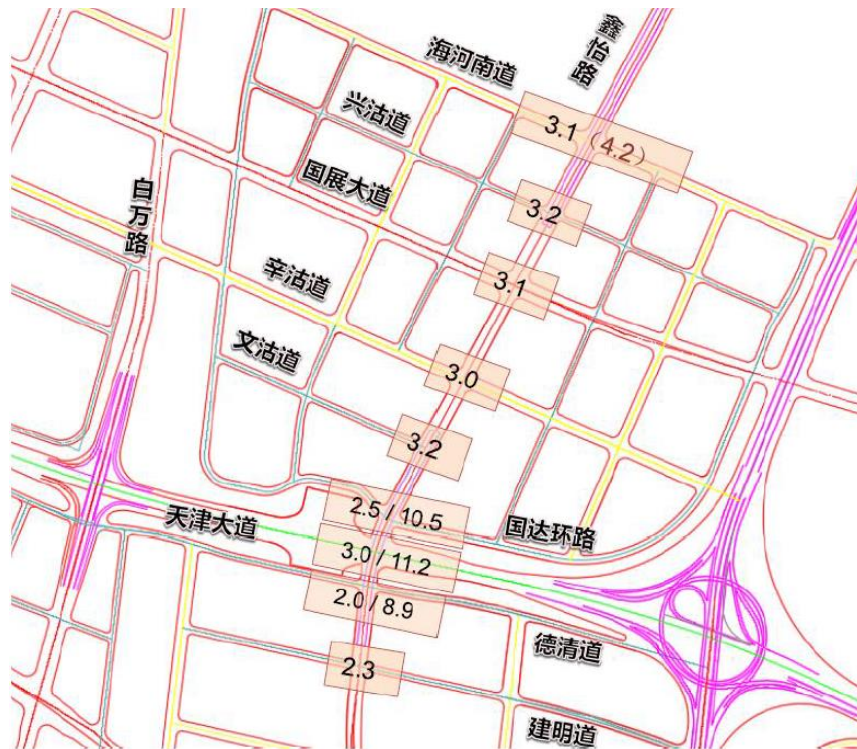
图8 各控制节点竖向设计情况
