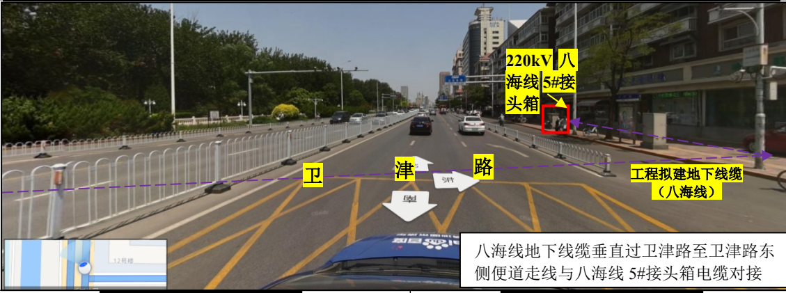
八延线地下线缆沿卫津路东侧便道走线与八延线 4#接头箱电缆对接
