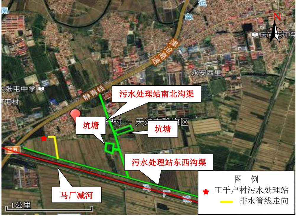
图 4-2 王千户村沟渠水力联系概况图
