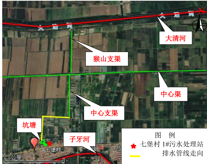
图 4-3 七堡村北侧水力联系概况图
