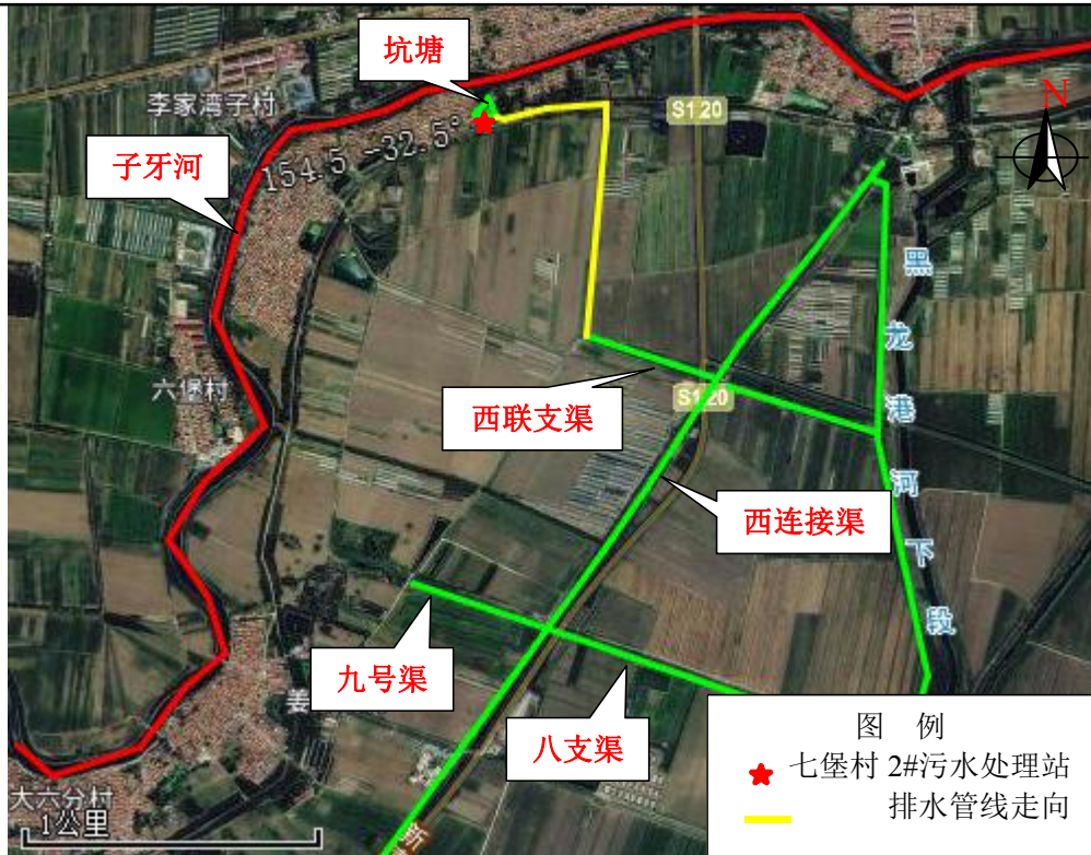
图 4-4 七堡村南侧水力联系概况图
