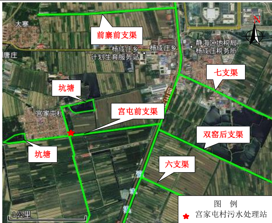
图 4-5 宫家屯村沟渠水力联系概况图
